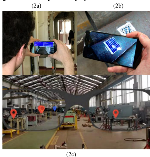
Slika 2. Upotreba „pametnog“ telefona za testiranje i čitanje informacija (2a i 2b) i lociranje potrebnih cevi putem „pametnih“ naočara (2c) [37] Figure 2 Application of a "smart" phone to test and read the information (2a and 2b) and locating of required pipes via "smart" glasses (2c) [37]
