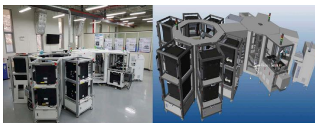
Slika 3: Mikro „pametna“ fabrika – fizički oblik (levo) i digitalni bliznac (desno) Izvor: (Park i drugi, 2019)
